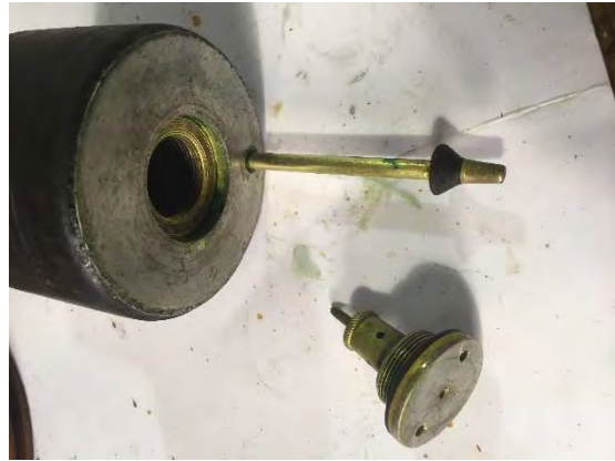
Particolare del fondo del pistone con la valvola durante la pulitura
