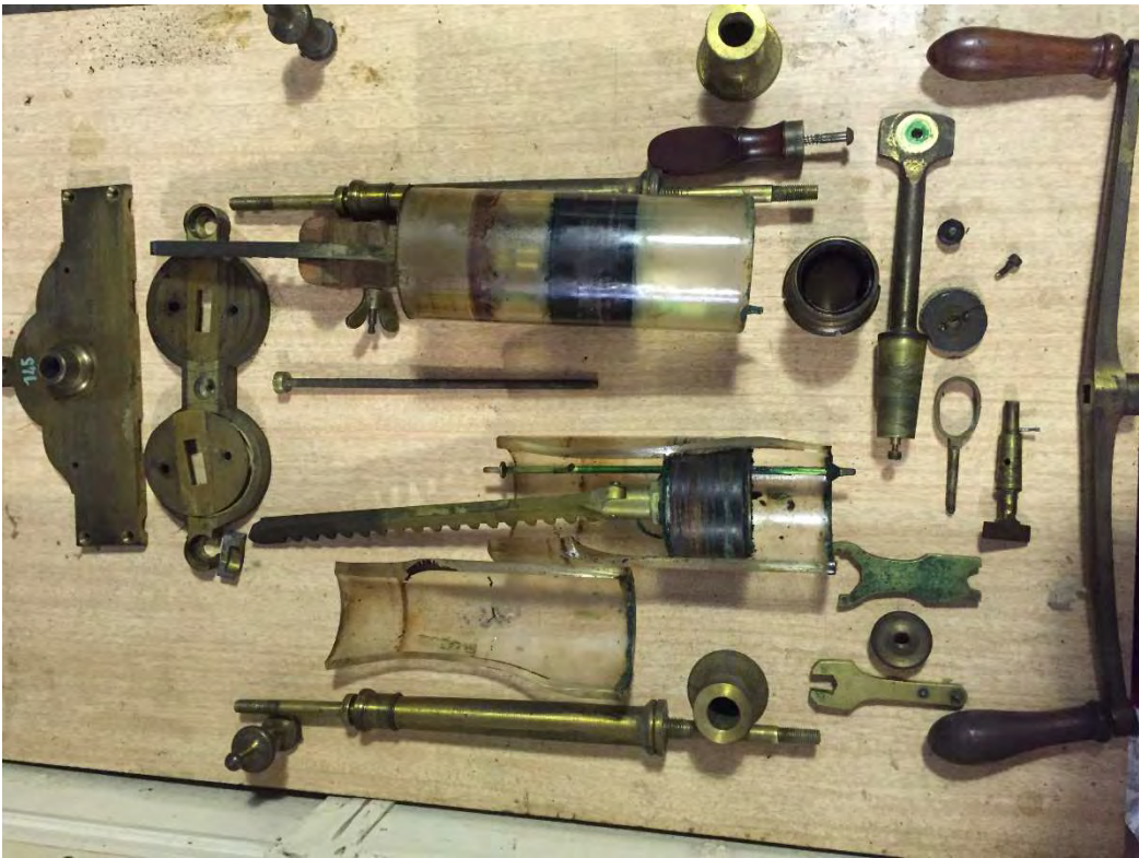
Le varie parti dopo lo smantaggio e prima della pulitura (si noti il cilindro spezzato)
