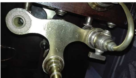
Particolare, notare assenza valvole per Circolazione dell'olio
