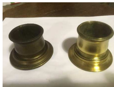
Un elemento prima e dopo pulitura e verniciatura
