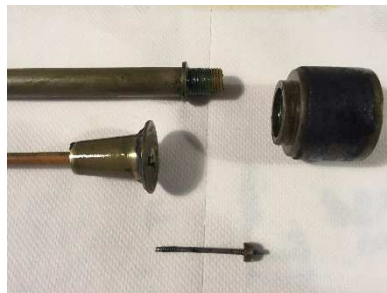
Sistema del pistone e sua valvola durante il restauro
