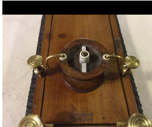
Particolare dell'interruttore mancante di parti dopo il restauro
