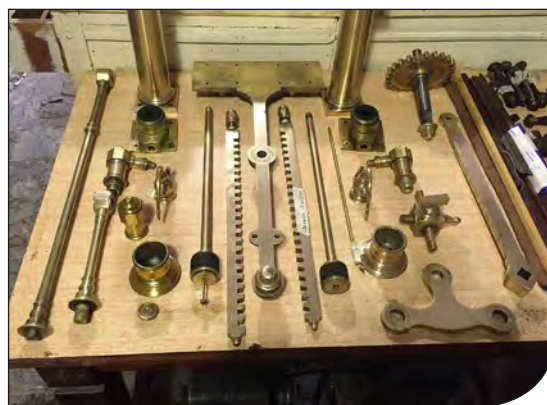
Fig. 2. Parti in ottone della pompa pneumatica, costruita da G. Albrici fra il 1791 e il 1793, durante il restauro.
